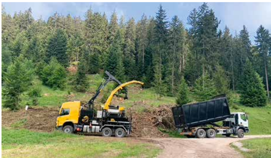
Macchina cippatrice su autocarro in funzione (foto Nicola Baldessari)
